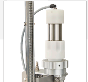
Control del tancat del clip a través d'un excèntric.
