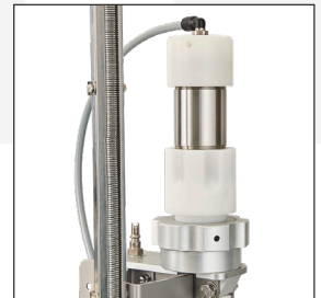
Steuerung des Clip-Verschlusses mit Hilfe eines Exzenters.
